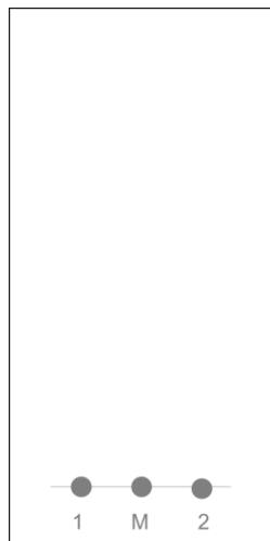
Fig.2 : TLC su gel di silice; soluzione eluente acetato di etile/esano 2:8. A=acido benzoico, C=cumarina, M=miscela.
